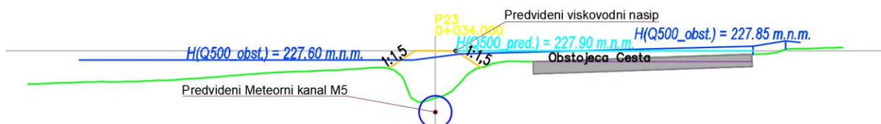
Slika 1: Karakteristični profil nasip nadvišanje ceste v PP23
